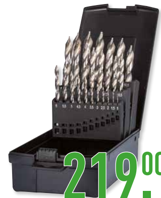
4001105209 Phantom HSS Set Spiraalboren DIN 338 Step-point HSS Met drievlaks schacht, korte geslepen uitvoering, met kruisaanslijping vanaf 1,0 mm, tophoek 118° Voor gecontroleerd boren. Boort absoluut rond en braamvrij!
